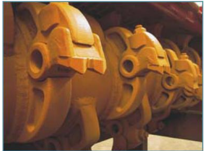
Rotor cu cutite fixe montate pe suporti masivi, forjati Disponibil pentru Miniforst, Midiforst si Midiforst d.t.
