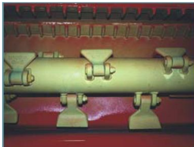
Optional, rotor cu ciocane montate in spirala si contractit din fier forjat
