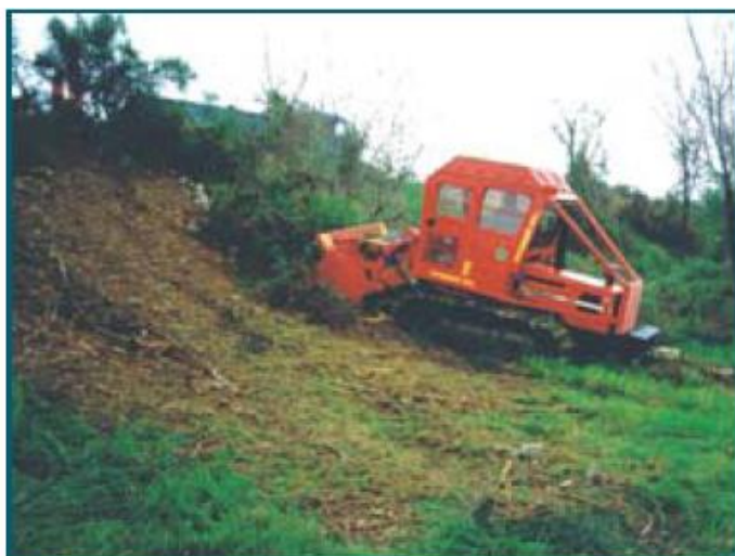
MIDIFORST montat pe un senilat la crearea unei benzi de protectie pentru incendii
